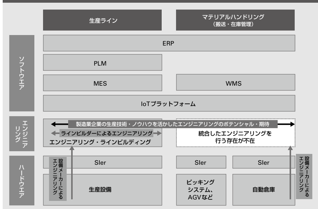
図5 現在の生産ライン・マテハンにおけるエンジニアリングとユーザー製造業企業の展開ポテンシャル
