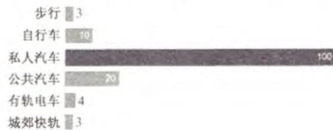
图1 城市中不同出行方式所需的空间面积 (m<sup>2</sup>) (来源: 根据参考文献1绘制)
