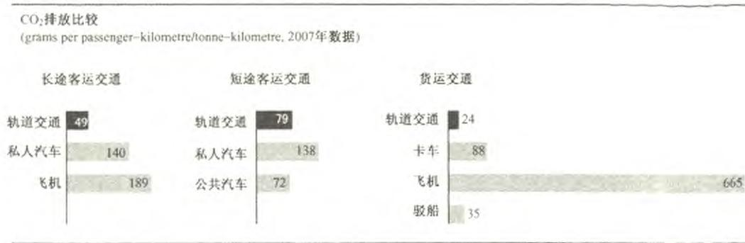
图3 各交通方式的CO<sub>2</sub>排放比较(来源:根据参考文献5绘制)
