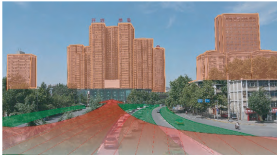
图5 开远门遗址处高大建筑对主风道南北向通风形成阻挡
