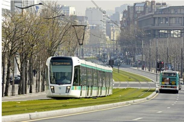
图 2 开放式路面轨道（3 号线）
