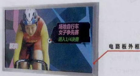
8 在大屏幕四边粘贴电路板外框
