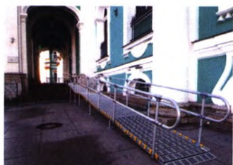
图6 德国历史建筑的铝制模块化坡道 [2]
