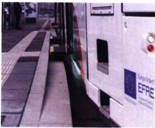
图 2 低层车辆平台 DIN 标准图例 [2]
