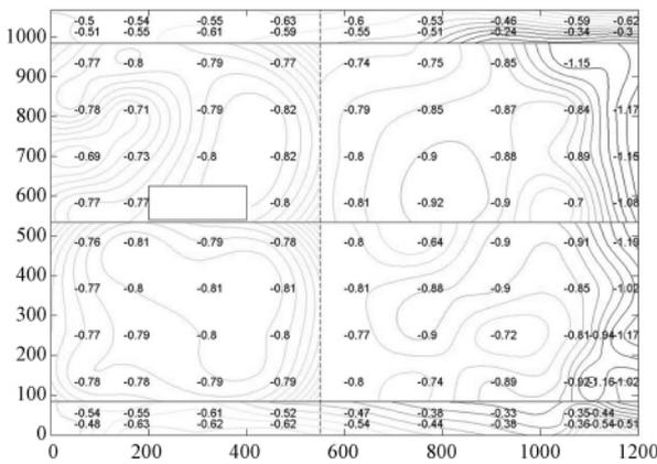
图15 屋面开洞结构90°风向角下内屋面平均风压系数分布
