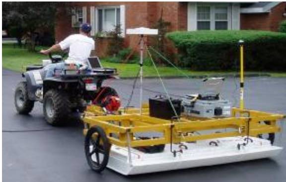
Fig. 11. UIT Multi-Channel GPR System with GPS
