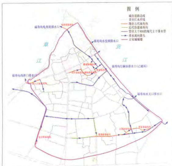
图6 福寿沟与现代排水系统的对接
