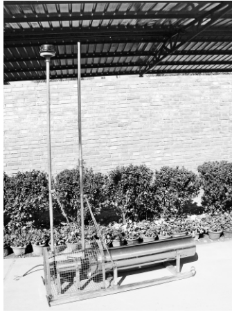
图5 潜水推流充氧设备
