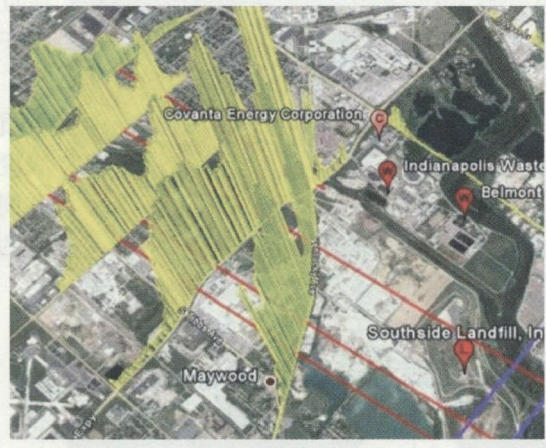
图 9 垃圾填埋场下风向的车载仪器 \text{CH}_4 测量结果
