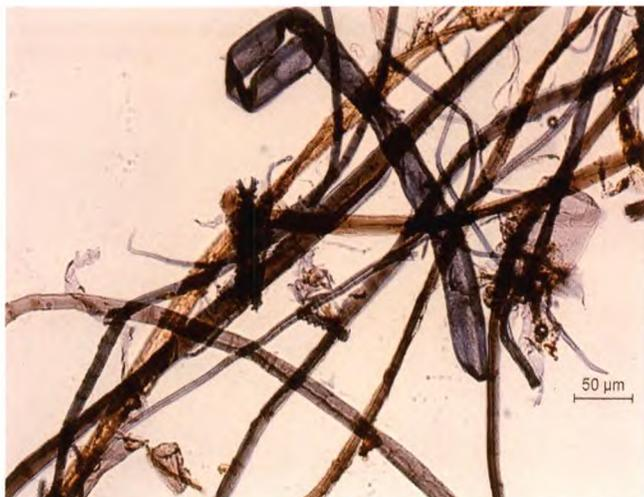
潘玉良 裸 1942 经仪器分析后发现纸浆中混杂了杂质、桑树皮、稻草与竹子纤维，推断纸质较接近我们现在所用的皮纸。
