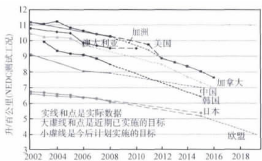
图2 世界各国乘用车燃油经济性标准目标对比 注: 图中所示的加拿大 2016 年目标值为 ICCT 的估计值, 而非官方公布值。纵坐标为乘用车燃油经济性标准值即平均燃油消耗限值, 单位为: 升/百公里( NEDC, 新欧洲驾驶循环工况)。
