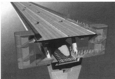
图 10 费曼恩海峡桥的专用管养和应急逃生通道
