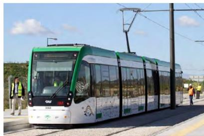
马拉加轻轨地铁是一个Y形线路、标准轨距路网, 2条线路从一个共同终端站El Perchel起始。1号线长6.7 km, 有10个车站, 线路向西运行, 经过安达卢西亚科技大学, 首段3.8 km是地下区段, 其余线路在路面。2号线长4.3 km, 有6个车站, 全部是地下线路, 向南运行。2条线路都安装了阿尔斯通的Urbalis 400 CBTC信号系统, 采用DC750V接触网供电。
